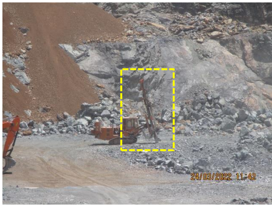
รูปที่ 3-5 เครื่องเจาะระเบิดที่มีอุปกรณ์เก็บฝุ่นติดไว้กับหัวเจาะ
